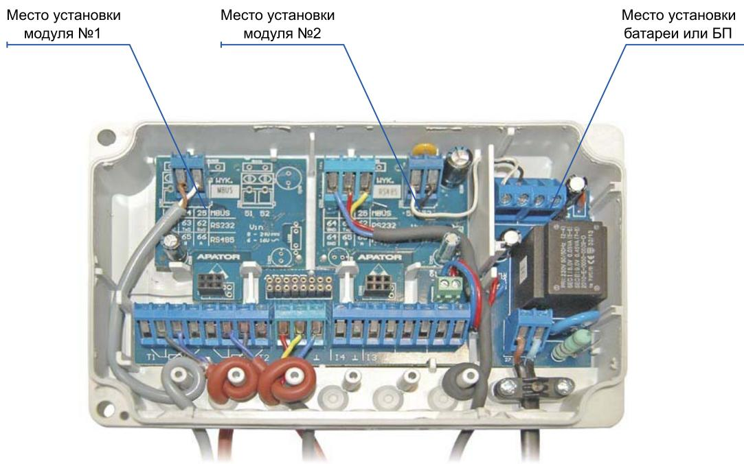
Представление нижней платы с соединительными клеммами и коммуникационными модулями а так же блоком питания 220V и способом закрепления кабелей в версии исполнения IP54
