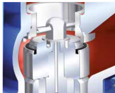
плунжер с эластичным уплотнением из PTFE (макс. 200°C только для стандартных значений Kvs)
